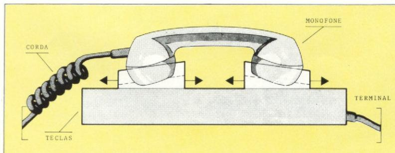
Figura 9 — Conexão do monofone ao acoplador
